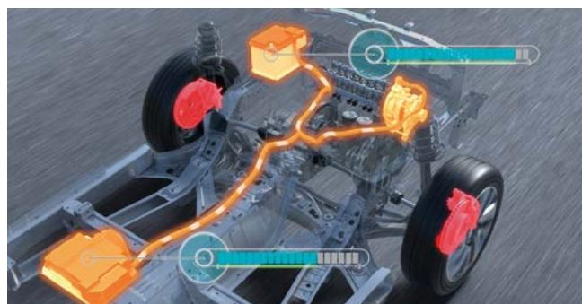
Spomaľovanie s rekuperáciou energie spolu so systémom Engine Auto Start Stop prispieva k znižovaniu spotreby paliva – tento hybridný systém je optimálny pre kompaktné vozidlá. Ponúka vynikajúcu úsporu paliva a zároveň je nenáročný na priestor.
